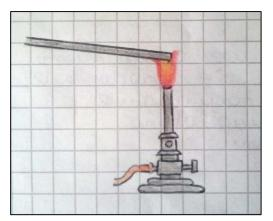
La propagazione per conduzione avviene tra corpi solidi a contatto aventi diversa temperatura. Il calore si propaga dal corpo più caldo a quello più freddo **senza spostamento di materia**. Per esempio, se avviciniamo ad una fiamma un'asticella metallica tenendola con la mano, è facile constatare che dopo un po' di tempo ci si scotta. C'è stato, quindi, un trasferimento di calore dalla fiamma, attraverso l'asticella, alla nostra mano.
