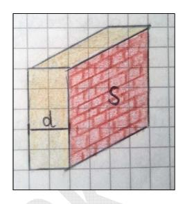
K è detto coefficiente di conducibilità termica ed è caratteristico del materiale costituente il conduttore. Se poniamo S=1, t=1 e  $(t_2-t_1)=1$  possiamo definire K come la quantità di calore che passa attraverso la parete di spessore unitario, estensione unitaria, con differenza di temperatura esterna ed interna unitaria e tempo unitario.
