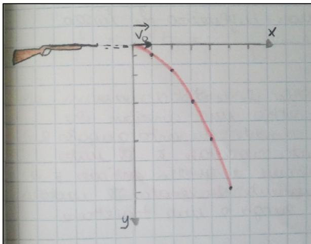
Si consideri il moto di un proiettile sparato orizzontalmente da un'arma da fuoco o il moto di un sasso lanciato anch'esso orizzontalmente. In entrambi i casi si tratta di un moto che è il **risultante di due moti simultanei**: quello orizzontale è il **moto rettilineo uniforme** e quello verticale è il **moto uniformemente accelerato**. Il moto risultante dà luogo a una **traiettoria parabolica**.
