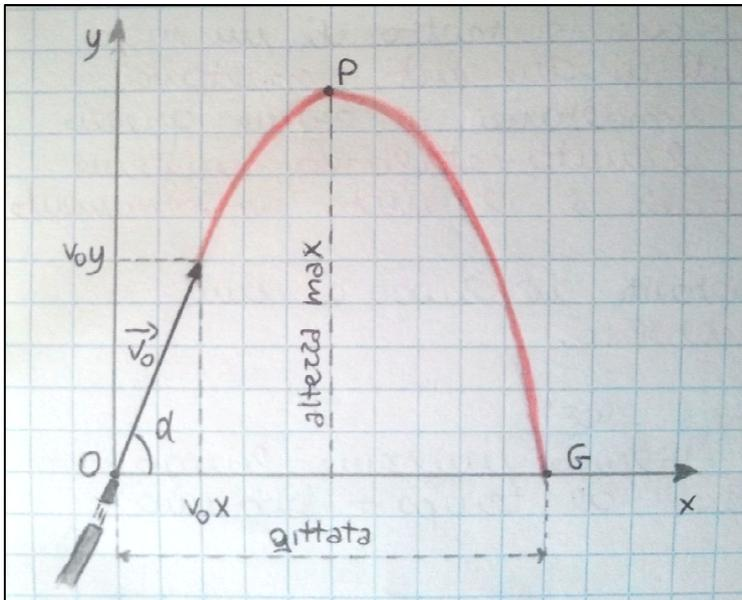
Si consideri ora il moto di un proiettile che abbia una direzione che formi con l'orizzonte un certo angolo  $\alpha$ . Il moto orizzontale è un **moto rettilineo uniforme**, mentre quello verticale è un **moto uniformemente decelerato**. Il moto risultante dà luogo a una **traiettoria parabolica**.
