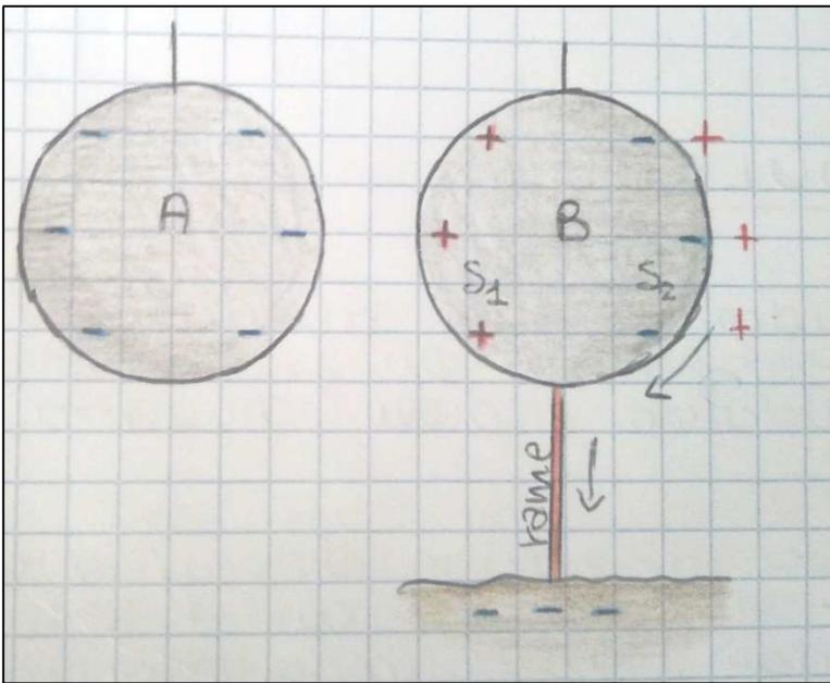
Avvicinando le due sfere, vediamo che le cariche negative di A respingono gli elettroni della zona  $S_1$  della sfera B. Tali elettroni si spostano nella zona  $S_2$ , che diventa negativa. Complessivamente però la sfera B è ancora elettricamente neutra.
